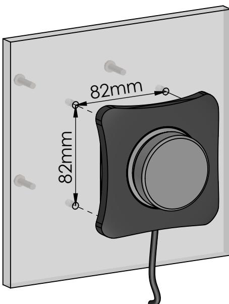
Vissé par l'arrière avec quatre Vis M5,
